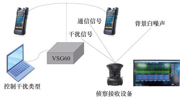
图1 干扰信号的产生与采集流程
